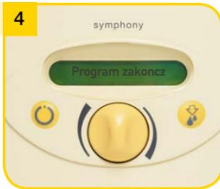
Program INICJACJA pracuje automatycznie przez 15 minut, wykorzystując fazy stymulacji, odciągania i przerwy. Zakończenie programu jest sygnalizowane dźwiękiem. Na wyświetlaczu pojawia się napis „Program zakoncz.”. Odciągacz wyłącza się automatycznie.
