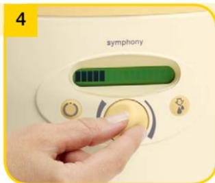
Ustawić komfortowe podciśnienie dla fazy odciągania (patrz rozdział 7.6). Słupki na wyświetlaczu wskazują poziom podciśnienia. Im więcej słupków, tym silniejsze podciśnienie.
