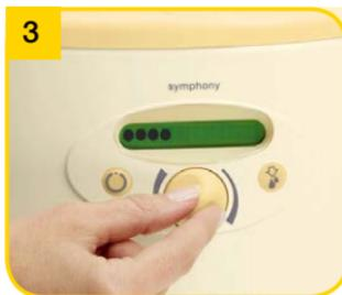
Indstil komfortvakuum (se afsnit 7.6). Prikkerne i displayet viser vakuumniveauet. Jo flere prikker, jo højere vakuum.
