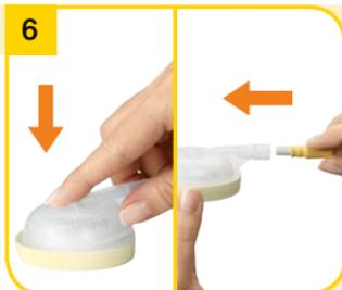
Umieścić membranę na płaskiej powierzchni okrągłą stroną skierowaną ku górze. Wcisnąć nasadkę na membranę, aż zablokuje się na miejscu. Włożyć końcówkę drenażu do otworu w nakładce membrany.
