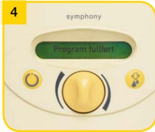
START-programmet går automatisk i 15 minutter med stimulerings-, utdrivings- og pausefase. Et lydsignal indikerer at programmet er slutt. Displayet viser «Program fullført». Pumpen slås av automatisk.
