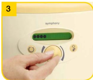
Ustawić komfortowe podciśnienie (patrz rozdział 7.6). Kropki na wyświetlaczu wskazują poziom podciśnienia. Im więcej kropek, tym silniejsze podciśnienie.
