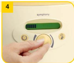
Indstil komfortvakuum for udpumpningsfasen (se afsnit 7.6). Bjælkerne på displayet viser vakuumniveauet. Jo flere bjælker, jo højere vakuum.
