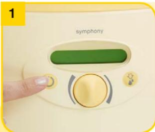
Nacisnąć przycisk on/off
