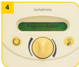
Programmet INITIERA körs automatiskt under 15 minuter med stimulerings-, utdrivnings- och pausfaser. En ljudsignal indikerar att programmet är slutfört. På displayen visas "Program slutfört". Pumpen stängs av automatiskt.
